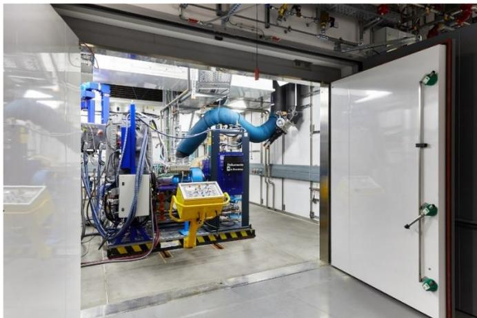
Dyno Testing Klimatestzelle mit Höhensimulation im SEGULA Technologies Engineering & Testing Campus Rüsselsheim. Bild: SEGULA Technologies, O. Roesler
